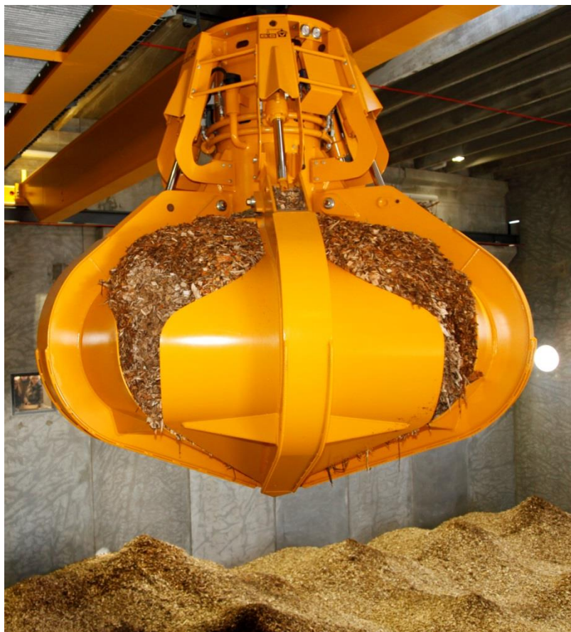
Kranen på biomasseanlægget
